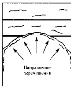
Рисунок 43 - Строительство насыпи с U-образным перемещением
