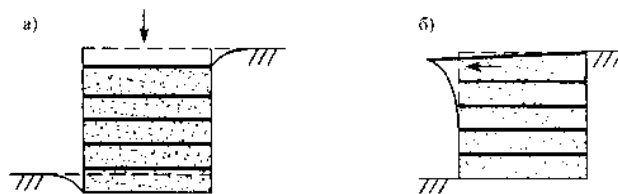
Рисунок 13 - Примеры предельных состояний устойчивости армогрунтовых стен
