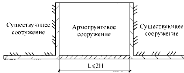
Рисунок 12 - Возведение сооружения между двумя существующими сооружениями
