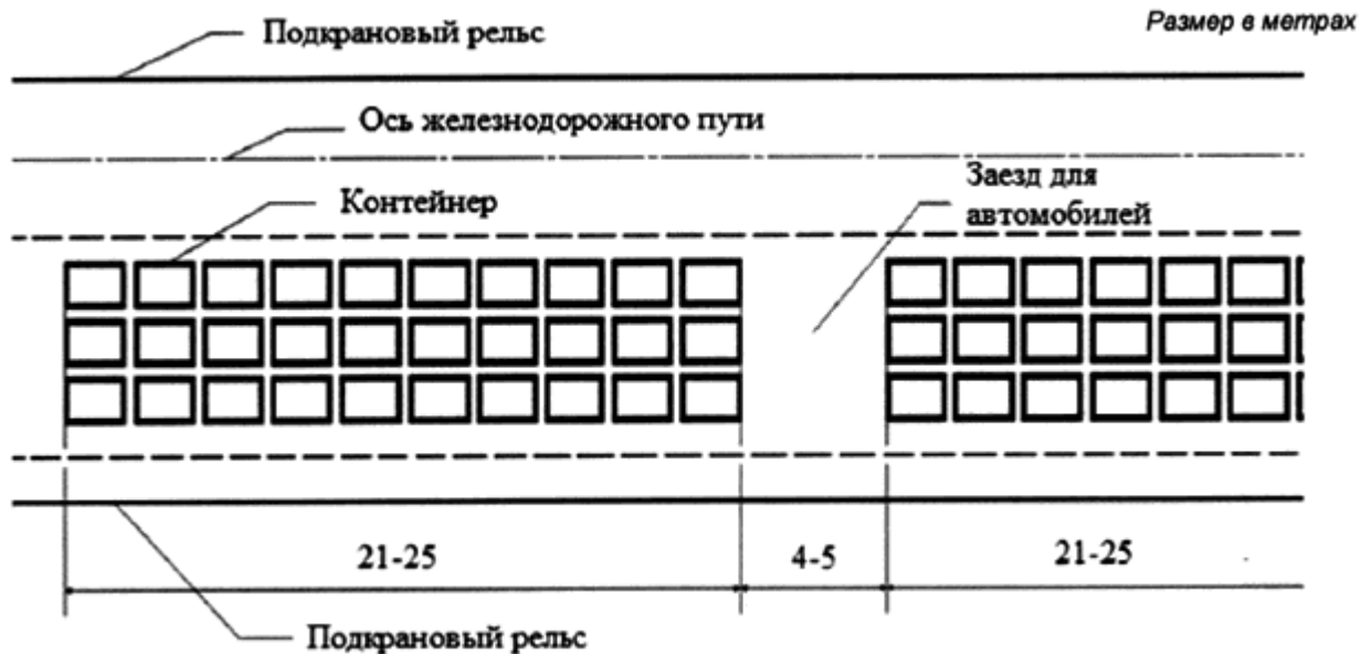
Рисунок 4 - Схема поперечного заезда автомобилей
