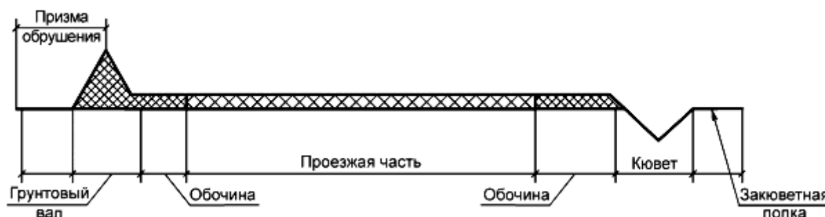
Рисунок 7.1а* - Поперечный разрез транспортной бермы
